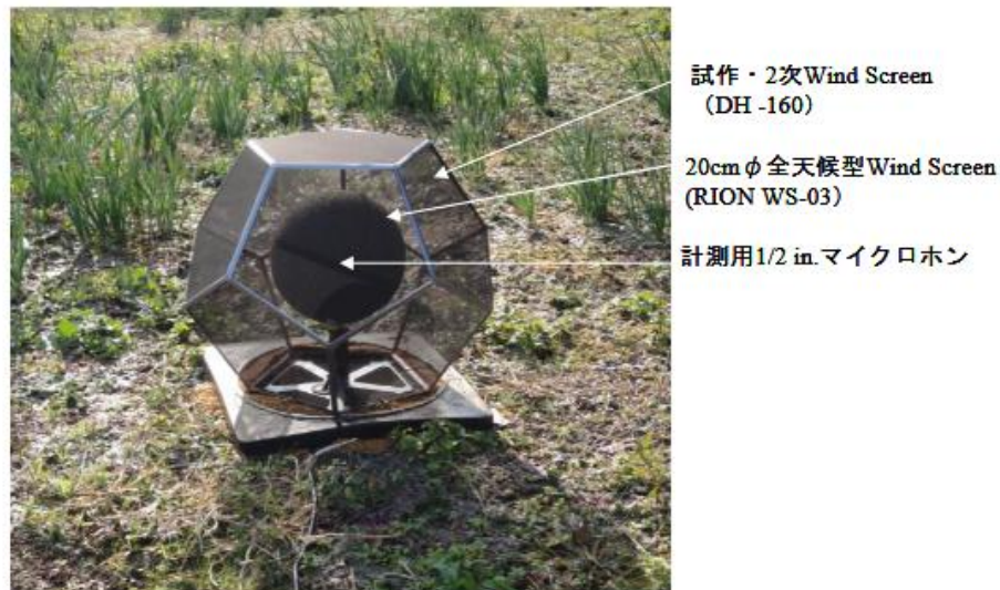
写真(1)-1 本研究で試作した二次防風スクリーン
